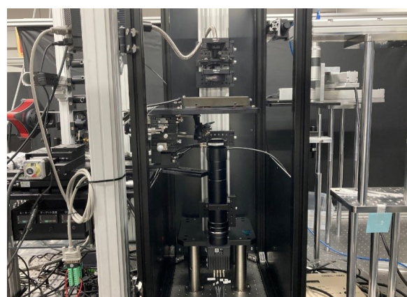
本領域で開発した、trans-scale-scope AMATERAS 1号機。
